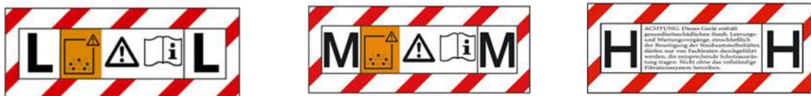
Abbildung 1: Kennzeichnung von L-, M- und H-Saugern (DIN EN 60335-2-69, Anhang AA)
